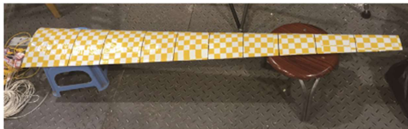
8 pav. Didelio proilgio lankstaus sparno bandomasis modelis naudotas aerodinaminiame vamzdyje [22]
