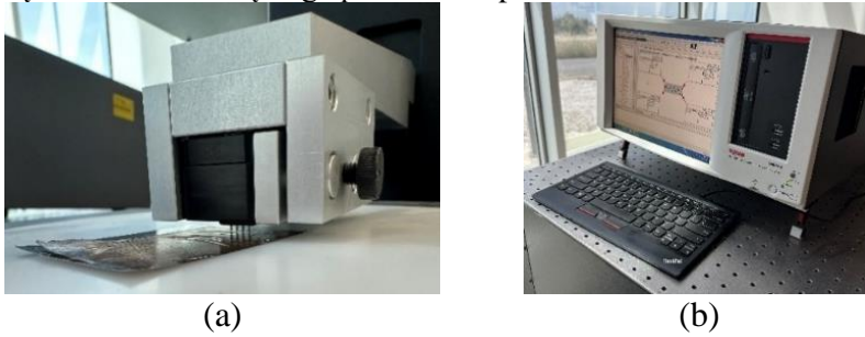
6.8 pav. Keturių taškų zondo metodo matavimo įranga: a) mėginio matavimas; b) 4200-SCS modelio puslaidininkių charakteristikų sistema
