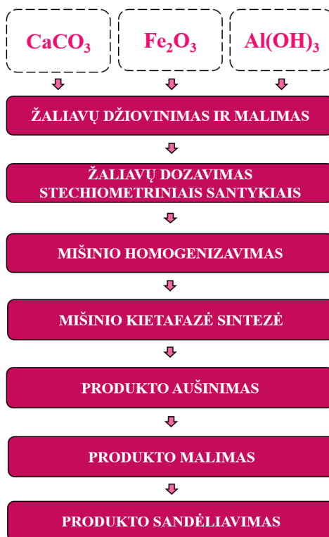
1.2 pav. Braunmillerito ( C_4AF ) gamybos proceso blokinė schema
