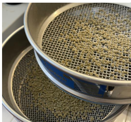
2.1.2 pav. Granulimetrinės trąšų sudėties nustatymas sietų metodu
