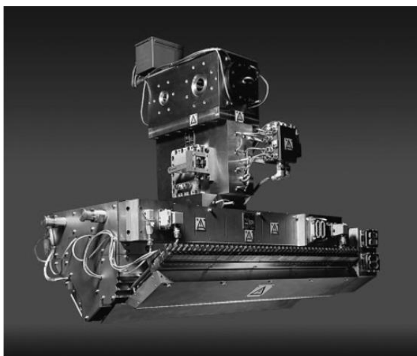
6 pav. Paskirstymo bloko kartu su liejimo galvute vaizdas iš šono [19]
