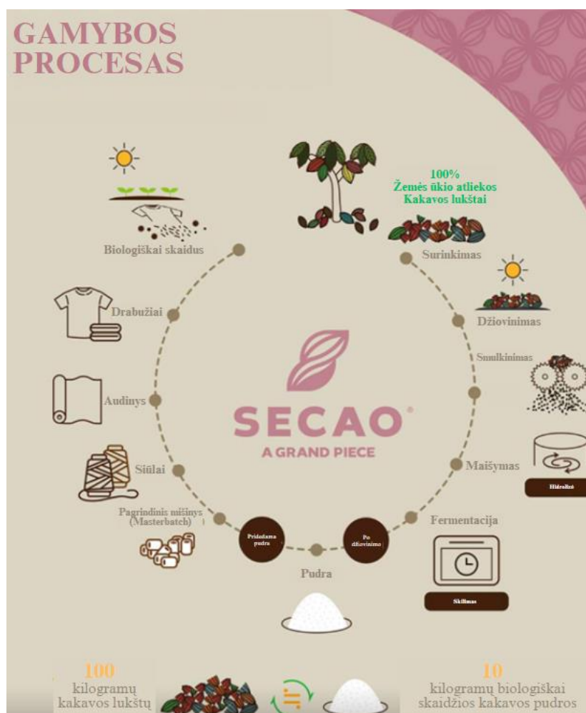
18 pav. Kakavos atliekų perdirbimas į biologiškai skaidų pluoštą [42]
