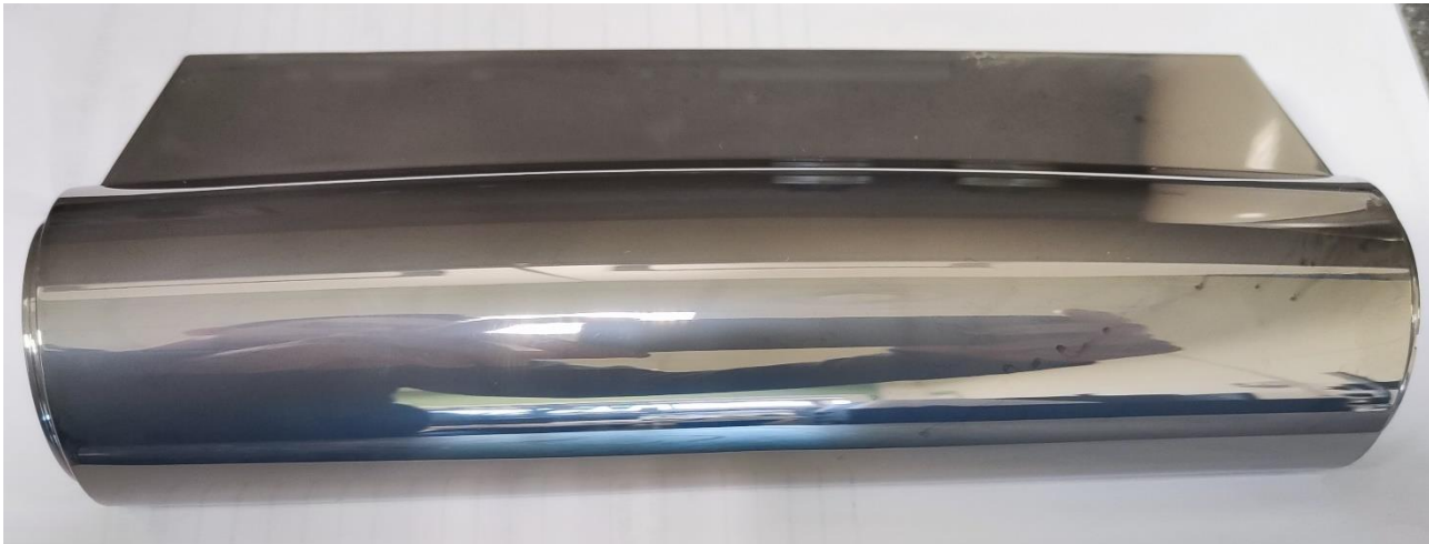
2 pav. Padengta detalė, naudojant cheminio nikeliavimo metodą (autorius nuotrauka)
