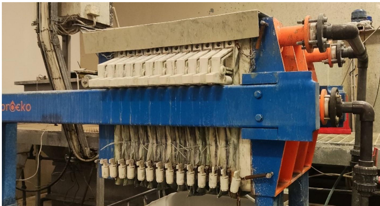
9 pav. Lėkštinis filtras-presas (autoriaus nuotrauka)
