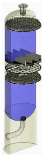
2 pav. Reaktorius su fiksuotu katalizatoriaus sluoksniu [11]
