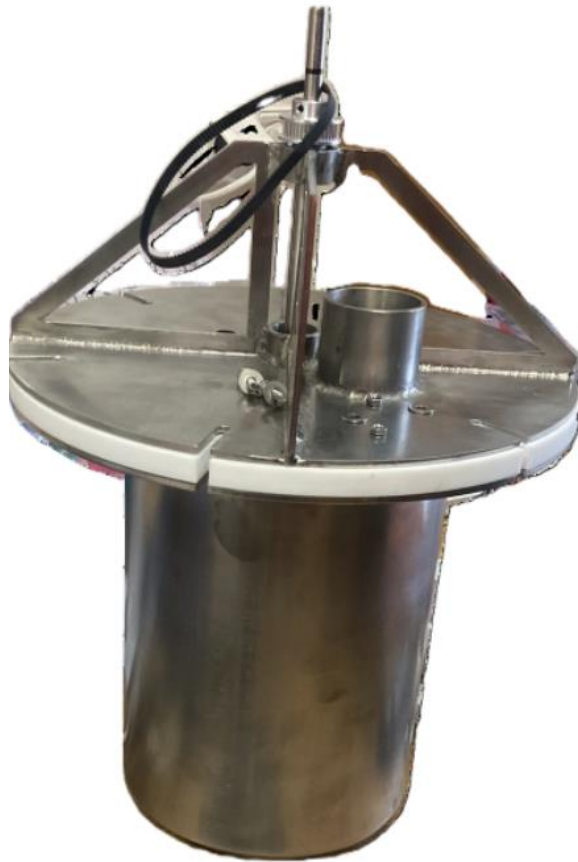
73 pav. Modelinis reaktorius pagamintas iš AISI 316 plieno
