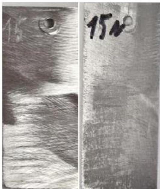
47 pav. AISI 316 markės plieno, 312 valandų paveikto 200 g/l koncentracijos 50 °C tirpalu, paviršiaus vaizdas
