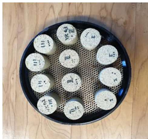
6 pav. Bandinių kietinimo CO 2 aplinkoje technologinė sistemos schema (a) ir sukietinti bandiniai (b): 1 – pneumatinis siurblys; 2 – monometrai; 3 – vožtuvai; 4 – rutulinė sklendė; 5 – CO 2 dujų balionas; 6 – temperatūros jutiklis; 7 – autoklavas; 8 – kaitintuvas-termostatas
