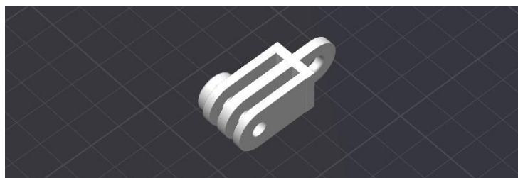
32 pav. Laikiklis skirtas virvei ir įrangai prisukti
