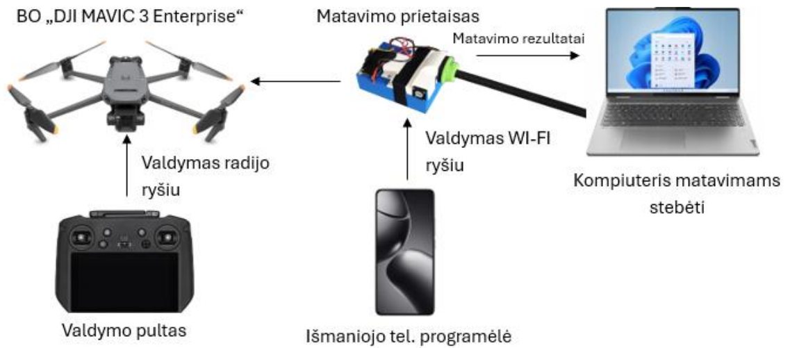
47 pav. Eksperimentinės sistemos schema, naudojant matavimo su vamzdeliu metodą
