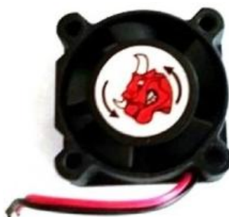
40 pav. Ventilatorius, naudojamas oro srautui vamzdelyje sukurti
