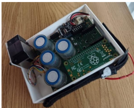
29 pav. Kenksmingų dujų ir kietųjų dalelių matavimo prietaisas
