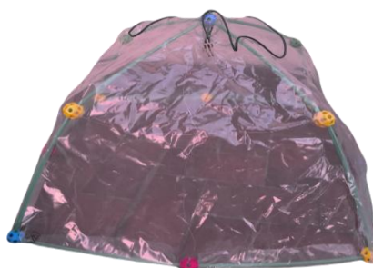
35 pav. Gaubtas matavimo įrangai apsaugoti
