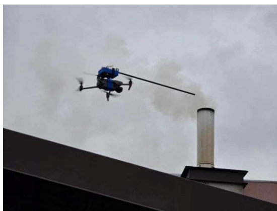
58 pav. Matavimas naudojant matavimo per vamzdelį metodą
