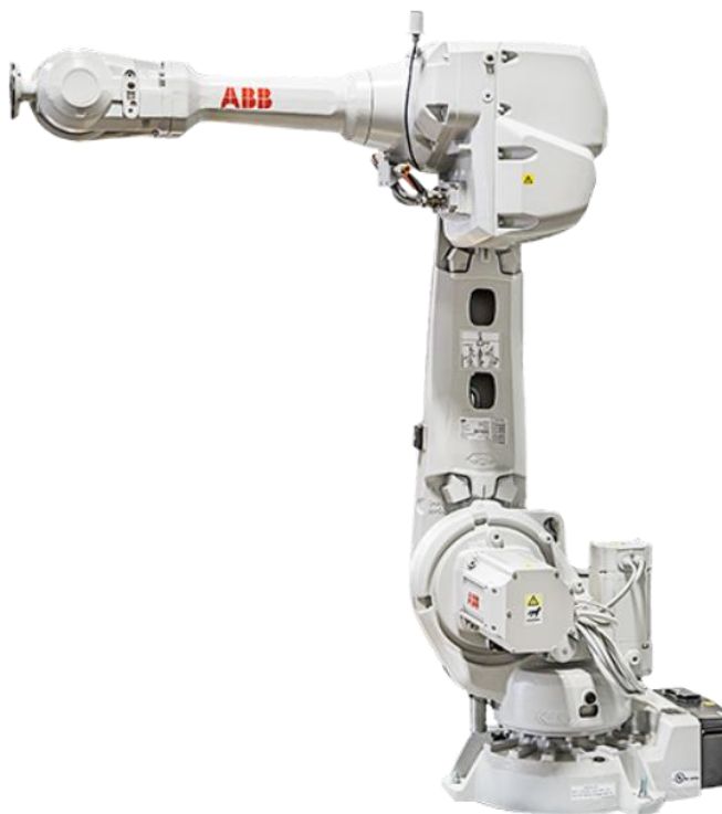
3 pav. Sistemos modelyje ir tyrime naudotas manipulatorius ABB IRB 4600.
