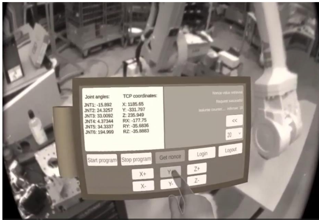
22 pav. Roboto koordinačių ir pasisukimo kampų atvaizdavimas virtualioje aplinkoje.
