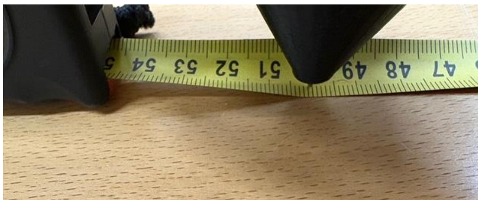
21 pav. Roboto galinio darbo įtaiso poslinkio matavimas.
