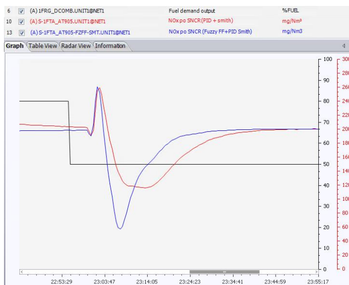
66 pav. NO x koncentracijos reakcijos į kuro srauto nuostatos pokytį 80-50 %
