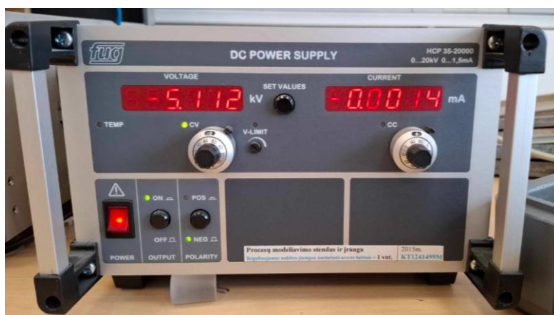
17 pav. Reguliuojamas aukštos įtampos nuolatinės srovės šaltinis „HCP 35-20000“
