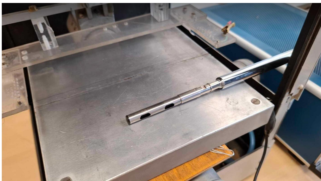
22 pav. Eksperimentinis stendas EHD oro srauto greičiui matuoti
