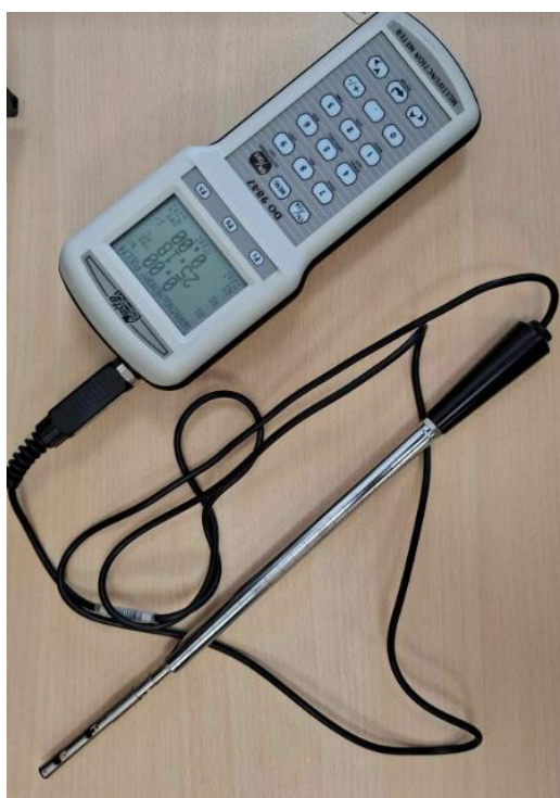
20 pav. Multifunkcinis matavimo prietaisas termo – anemometras
