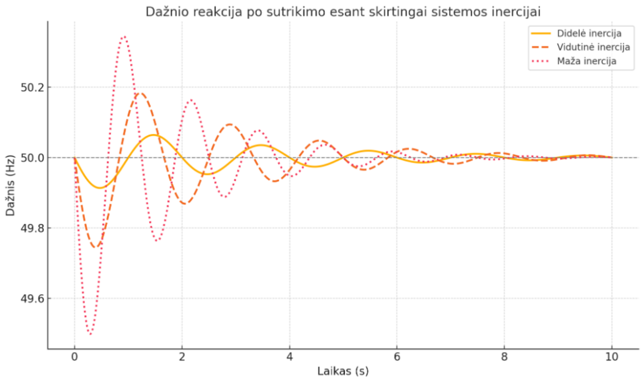
4 pav. Dažnio reakcijos po tinklo sutrikimo esant skirtingoms sistemos inercijos konfigūracijoms.
