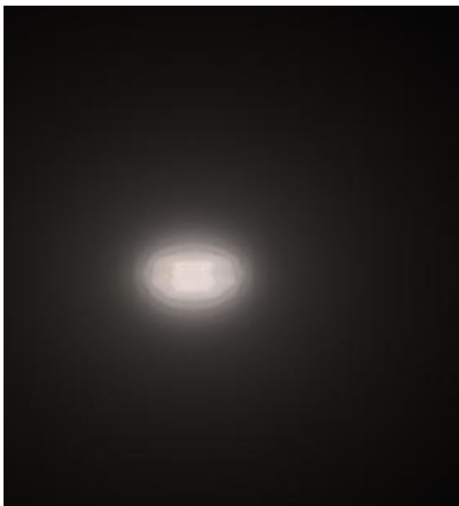
5.26 pav. Stabdžių signalo matomumas esant 10 metrų nuo jutiklio
