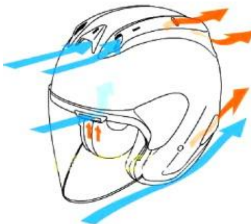
1.11 pav. Ventiliacijos sistema [8]
