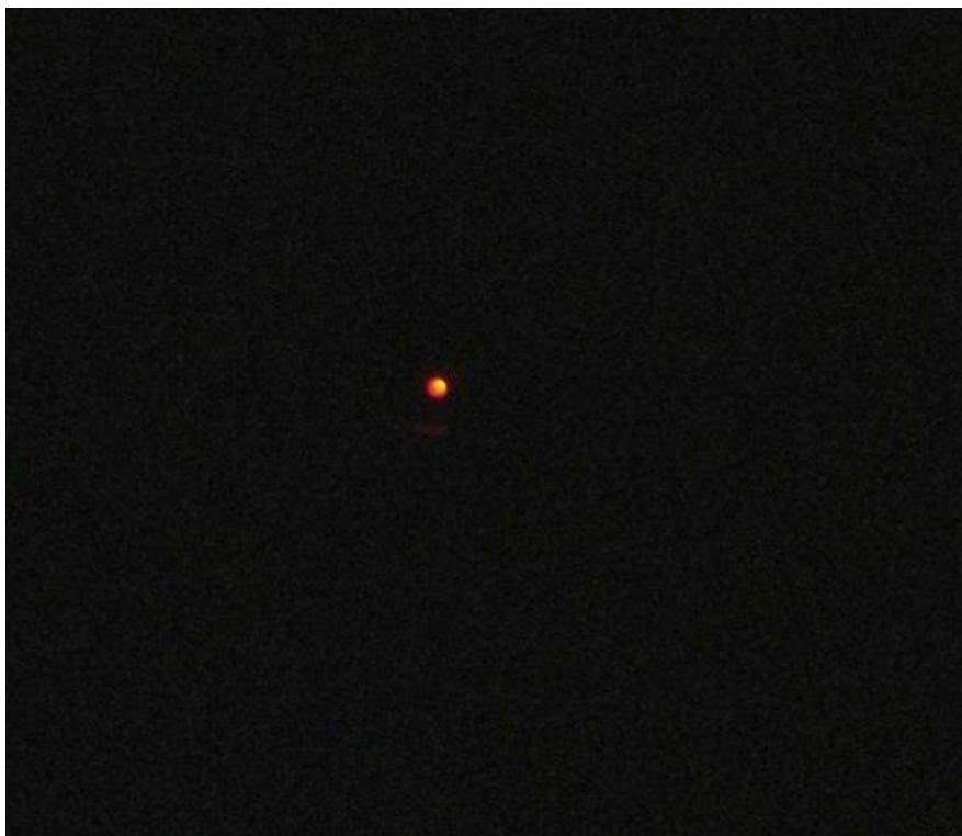
5.41 pav. Stabdžių signalo matomumas nutolus per 70 metrų
