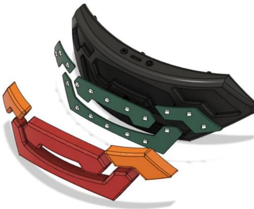
3.1 pav. Žibinto dalių išskaidymas bei šviesos elementų išdėstymas
