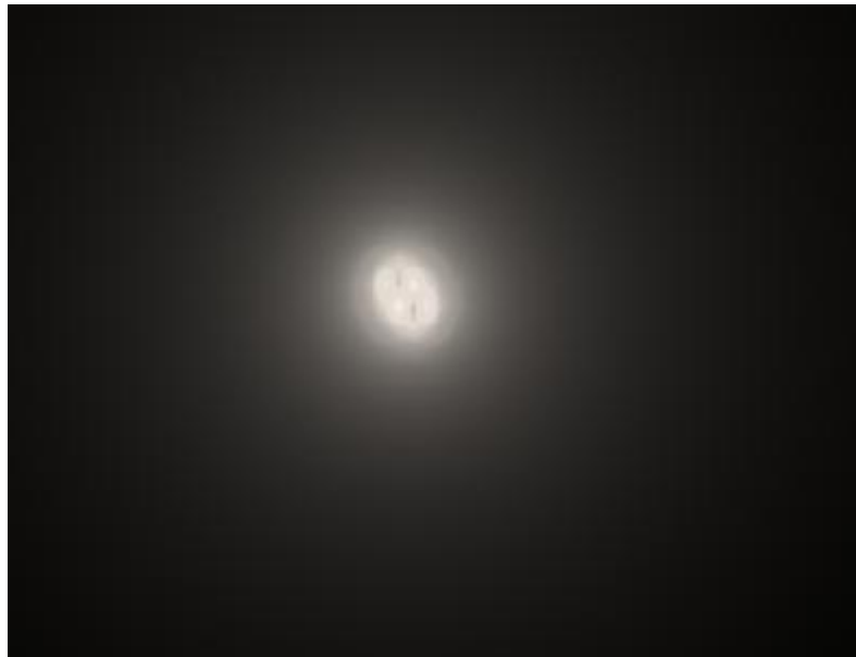
5.19 pav. Kairės pusės posūkio signalo matomumas esant 15 metrų nuo jutiklio
