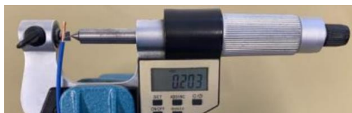
22 pav. Vario laido gija naudota tiriamuosiuose sparno modeliuose
