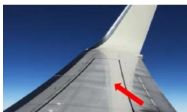
6 pav. Sparno paviršiuje matoma sužadino banga [22]
