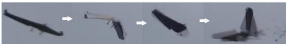
4 pav. Keturi sparno flaterio fazės: sparnas stabilus, flateruojantis bei struktūriškai pažeistas [18]
