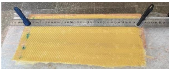
25 pav. Kompozitinės plokštelės rankinis pjaustymas
