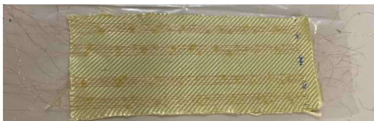
24 pav. Laidų gijos ant pirmo aramido pluošto audinio sluoksnio prieš tolimesnį kompozito sluoksniavimą ir impregnavimą
