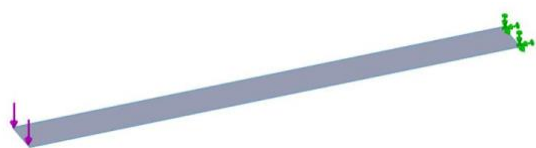
11 pav. Sparno lenkimo analizėje modeliuojama jėgos kryptis ir įtvirtinimai SolidWorks
