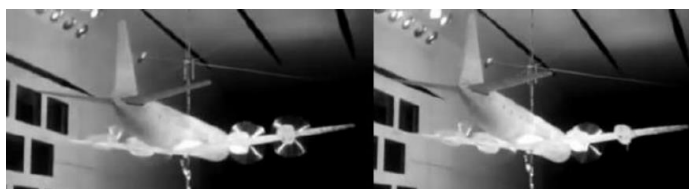
5 pav. Dvi sukurio flaterio fazės: propeleriai stabilūs bei sustoję propeleriai dėl flaterio reiškinio [20]
