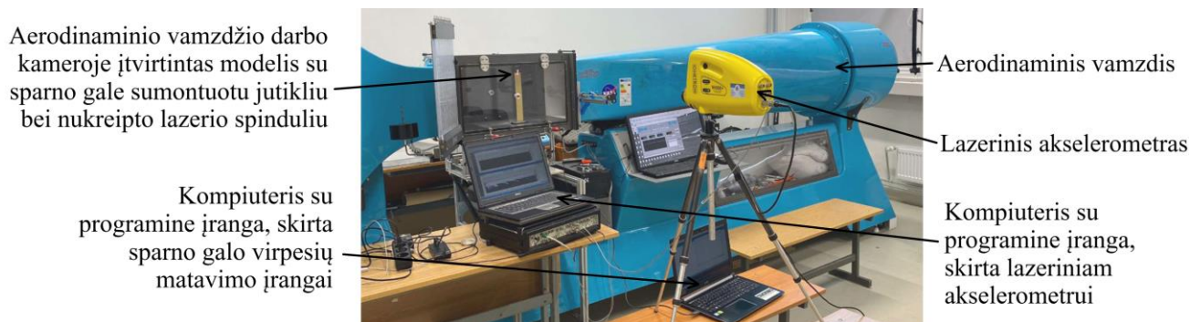
39 pav. Eksperimento aplinkos vaizdas naudojant sparno galo virpesių tyrimų įrangą ir lazerinį akselerometrą
