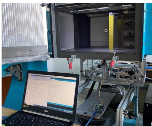
36 pav. Eksperimento aplinkos vaizdas naudojant sparno galo virpesių tyrimų įrangą
