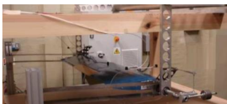
9 pav. Vibracinio tyrimo stendas su sparno modeliu ir matavimo įranga [31]
