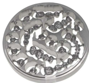
1.11 pav. Dantų protezai pagaminti frezavimo metodu [42]
