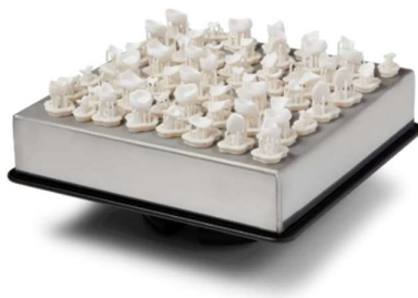
1.12 pav. Dantų vainikai pagaminti 3D spausdinimo (SLA) metodu [49]
