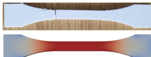
1.24 pav. Tempimo bandinių vaizdas po eksperimento [30]
