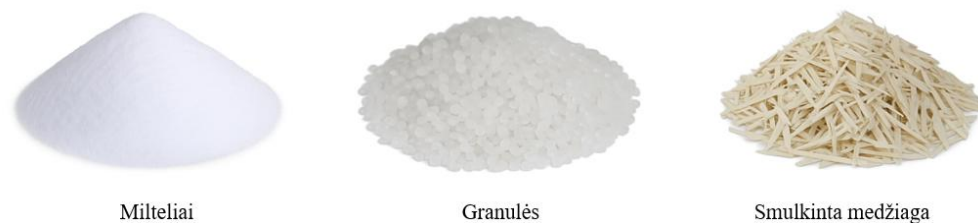
2.3 pav. Termoplastinių žaliavų formos kompozitų gamybai [50]
