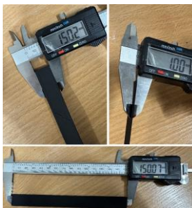
2.13 pav. Adityvios gamybos būdu pagamintų bandinių geometriniai parametrai
