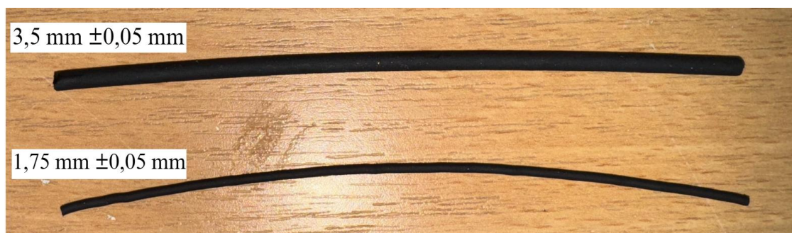
2.7 pav. TPC ir grafeno 3D spausdinimo gijų skersmens palyginimo vaizdas
