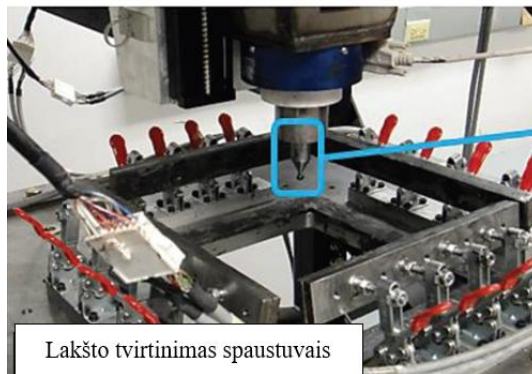
1.7 pav. Ruošinio tvirtinimas rankiniais spaustuvais [11]
