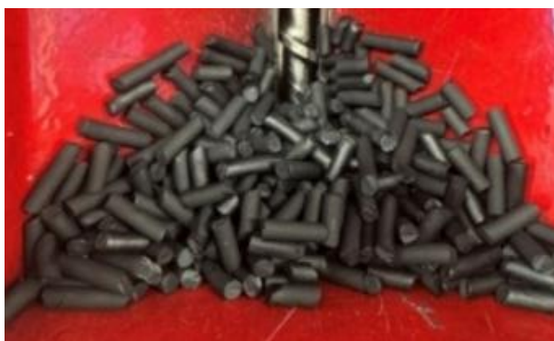
2.8 pav. 3D spausdinimo gijos granulės
