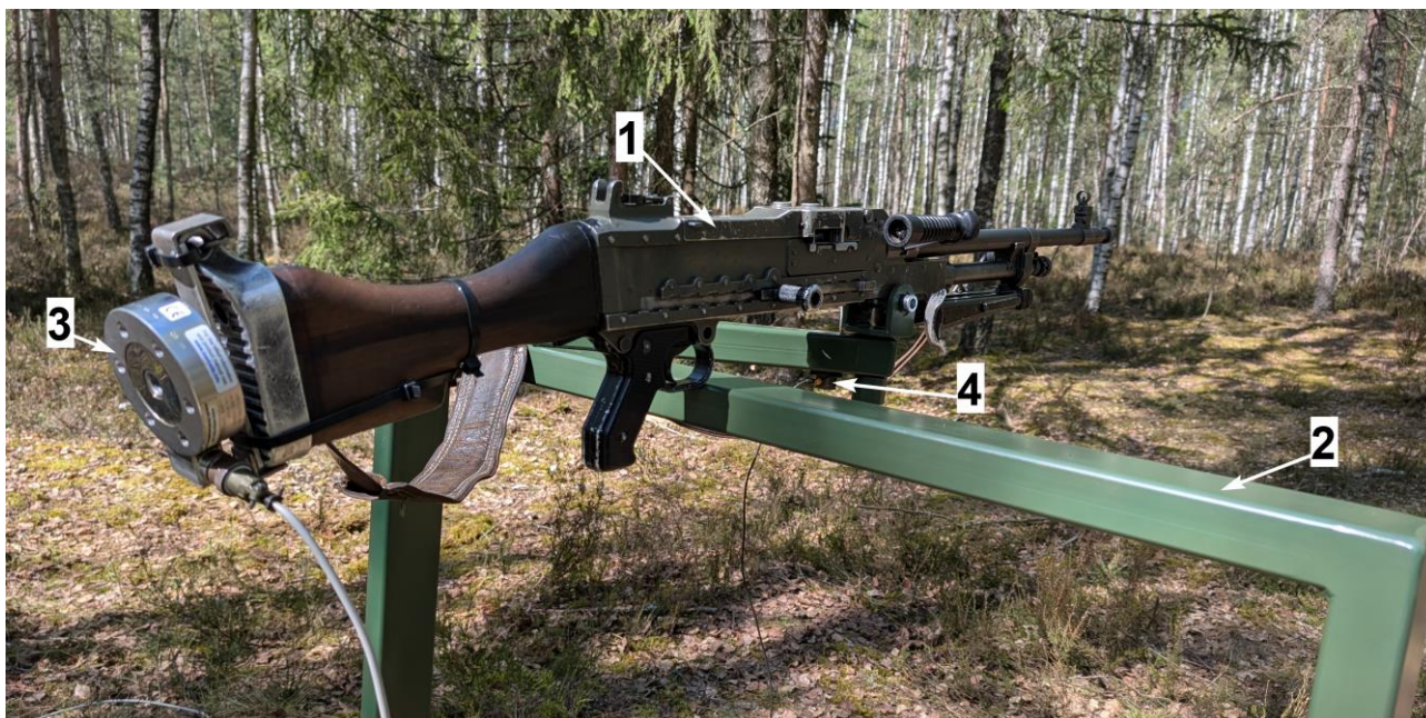
26 pav. Tyrimo įranga (1 – kulkosvaidis FN MAG KSP – 58, 2 – lafetas, 3 – pjezoelektrinis sensorius, 4 – akselerometras.)
