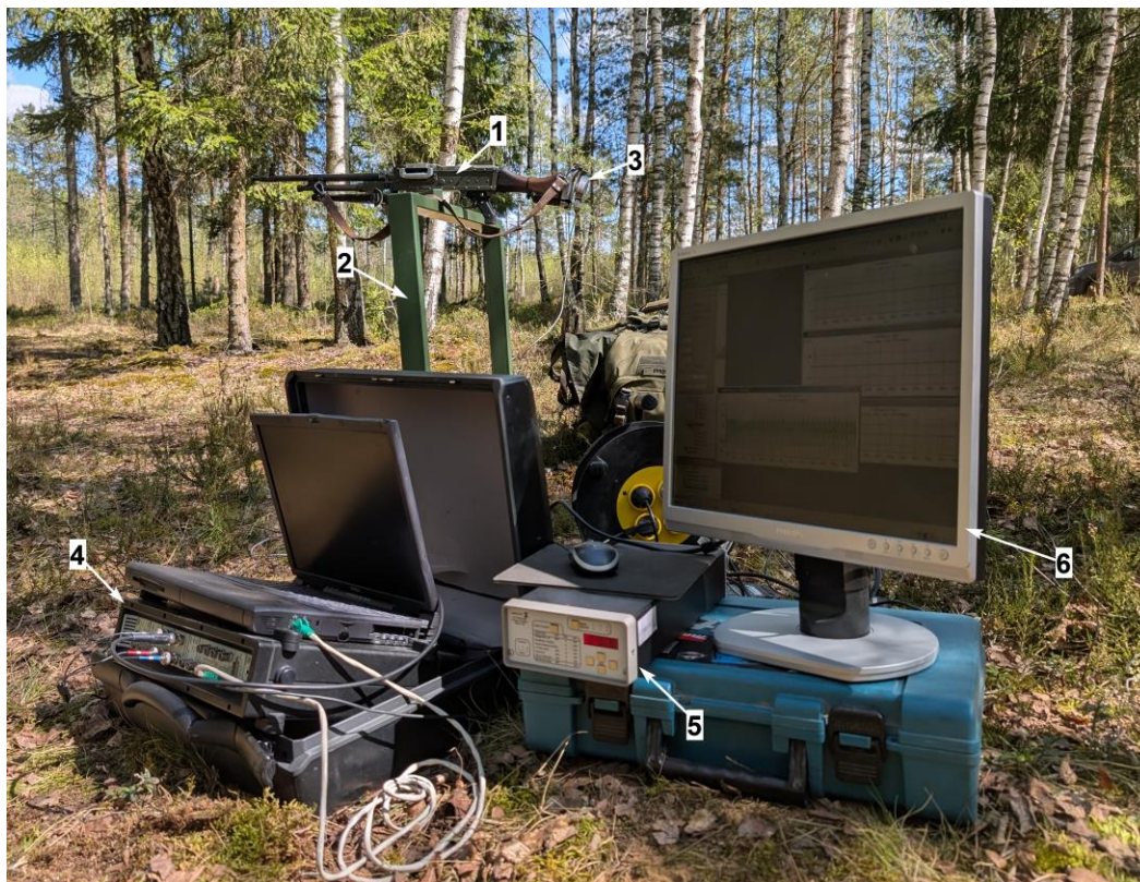
24 pav. Tyrimo įranga (1 – kulkosvaidis FN MAG KSP – 58, 2 – lafetas, 3 – pjezoelektrinis sensorius, 4 – analizavimo blokas, 5 – stiprintuvas, 6 – ekranas.)
