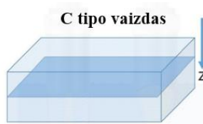
11 pav. Ultragarso inspekcijos C tipo vaizdo padėtis bandinio atžvilgiu [45]
