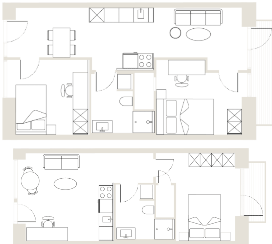
35 pav. „Classic“ dviejų lovų buto planas (viršuje) ir „Premium“ vienos lovos buto planas (Nido Bryggen, 2023)
