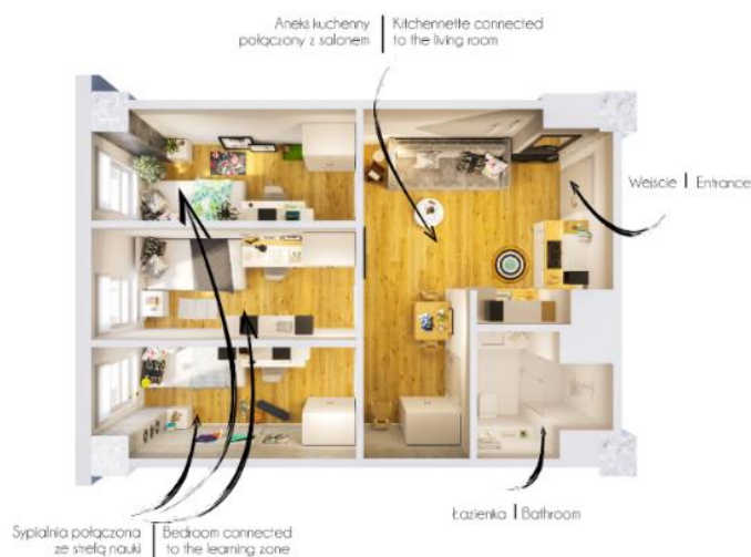
21 pav. 48 m 2 trijų asmenų buto išplanavimas (LivinnX, 2023)
