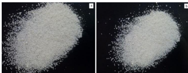
3.2.1.1 pav. Rotaciniu granuliatoriumi sugranuliuoto produkto nuotraukos naudojant: a – KDF ir vandenį; b – KDF, MC–1 ir vandenį
