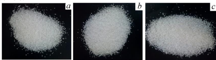
3.2.2.1 pav. Granuliuoto produkto, gauto granuliuojant naudojant: a – KDF ir vandenį; b – KDF, MC–1 ir vandenį; c – KDF, MC–2 ir vandenį, granulių nuotraukos
