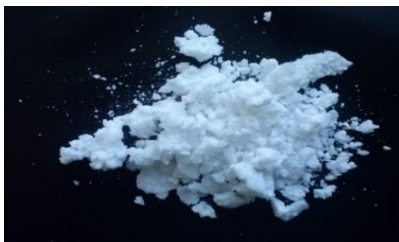
3.1.2.7 pav. Kristalinis KDF, gautas esant \text{KCl}:\text{NH}_4\text{H}_2\text{PO}_4 = 0,8 : 0,2 ir 60 °C temperatūrai
