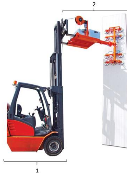
1.6 pav. Forklift Verti-Clad vakuuminis griebtuvas pritvirtintas prie elektrinio šakinio automobilinio krautuvo [7]: 1 – automobilinis krautuvas; 2 – vakuuminis griebtuvas
