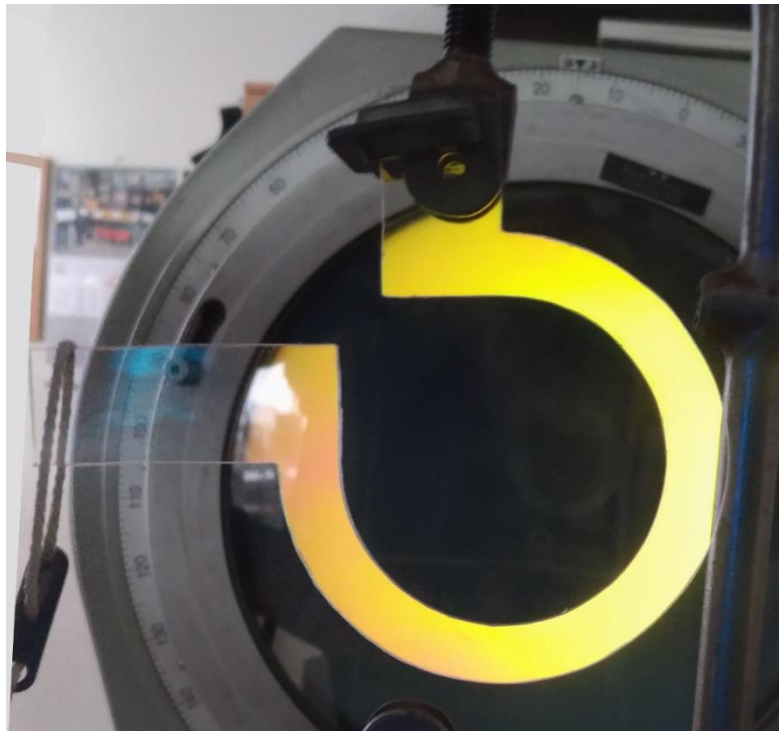
3.2 Pav. Paslankiojo mechanizmo lanksti jungtis paruošta eksperimentinei daliai
