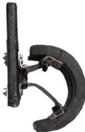
1.18 Pav. Mahler'io protezinio kelio sąnario prototipas [21]
