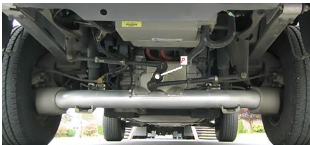
1.28 Pav. Automobilio pakaba – Watt'o mechanizmo panaudojimas [8]
