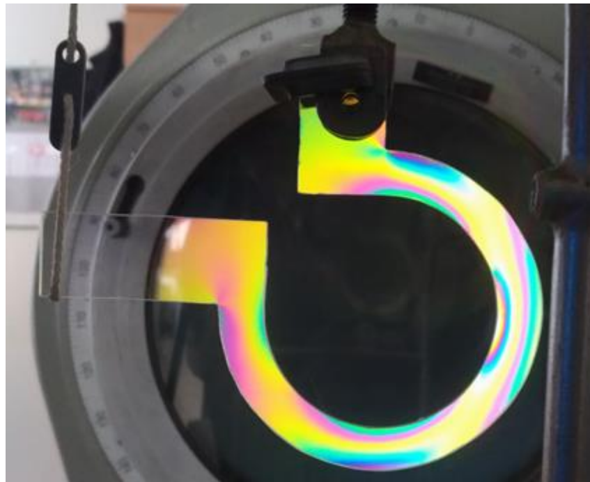
3.7 Pav. Paslankaus mechanizmo jungties įtampių pasiskirstymo vietos eksperimento metu
