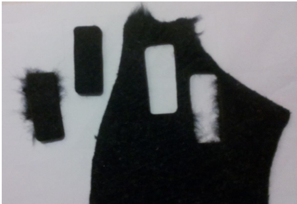
5.11 pav. Iš sintetinio veltinio išpjautos detalės
