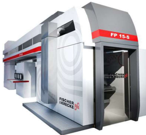
8 pav. Fleksografinė spaudos mašina Fisher & Krecke FP 16-S [21]
