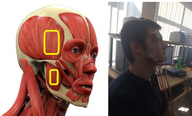
2.1 pav. Raumenys, naudoja EMG įrašų metu (kairėje) ir elektrodų išdėstymas sEMG įrašams atlikti (dešinėje)
