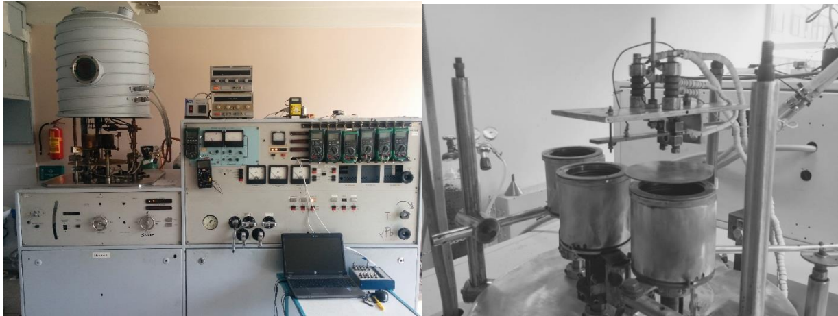
3.1.2 pav. Magnetroninio nusodinimo sistema (kairėje), kameros vidus su magnetronais (dešinėje) [50]
