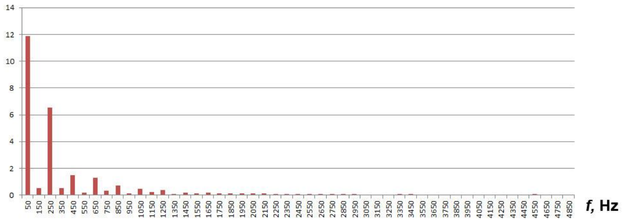
45 pav. Kondensatorinio variklio kondensatorinės apvijios srovės spektras
