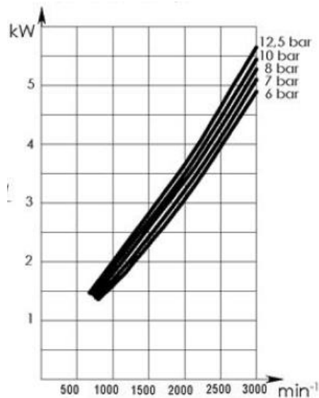
4.4 pav. Teoriniai kompresoriaus parametrai (reikalingos galios matavimas)
