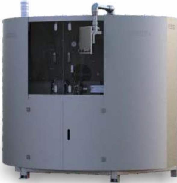
1 pav. Tiriamųjų kompresorių kontrolinių matavimų bandymo stendas
