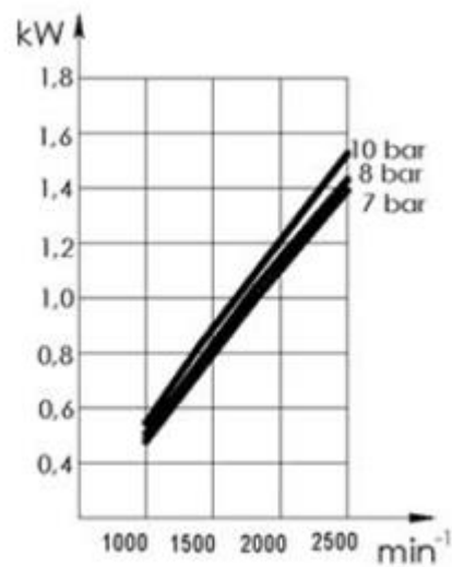
4.2 pav. Teoriniai kompresoriaus parametrai (reikalingos galios matavimas)
