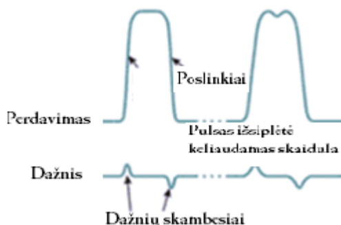
2.3.2.1 pav. Savosios fazės moduliacijos įtaka signalo impulso pločiui [12]
