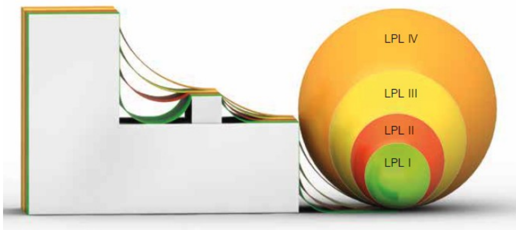
4.1 pav. Sferos spindulys priklausomai nuo skirtingo apsaugos klasės (LPL – apsaugos nuo žaibo kategorija) [4]
