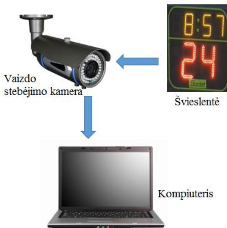
3.1.1 pav. LED segmentų skaitmenų, esančių rezultatų švieslentėje, aptikimo ir atpažinimo sistema
