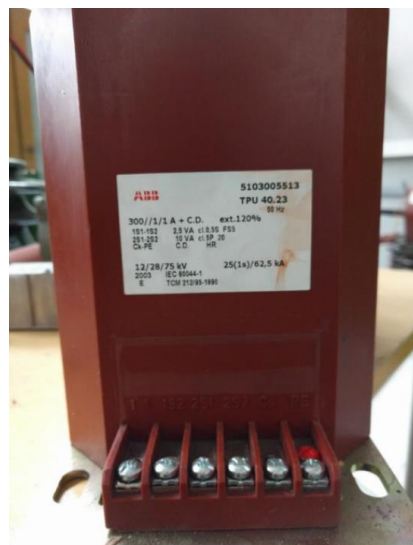
8.2 pav. Srovės transformatoriasu TPU 40.23 parametrai
