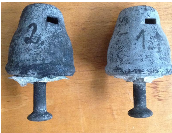
3.9 pav. Bandymų metu sudužę izoliatoriai.
