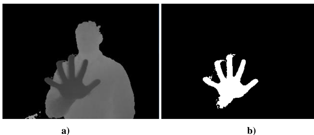
4.5 pav. a - gylio kadras, b - binarinė matrica, kurioje baltai pažymėti taškai, patenkantys į analizuojamą diapazoną
