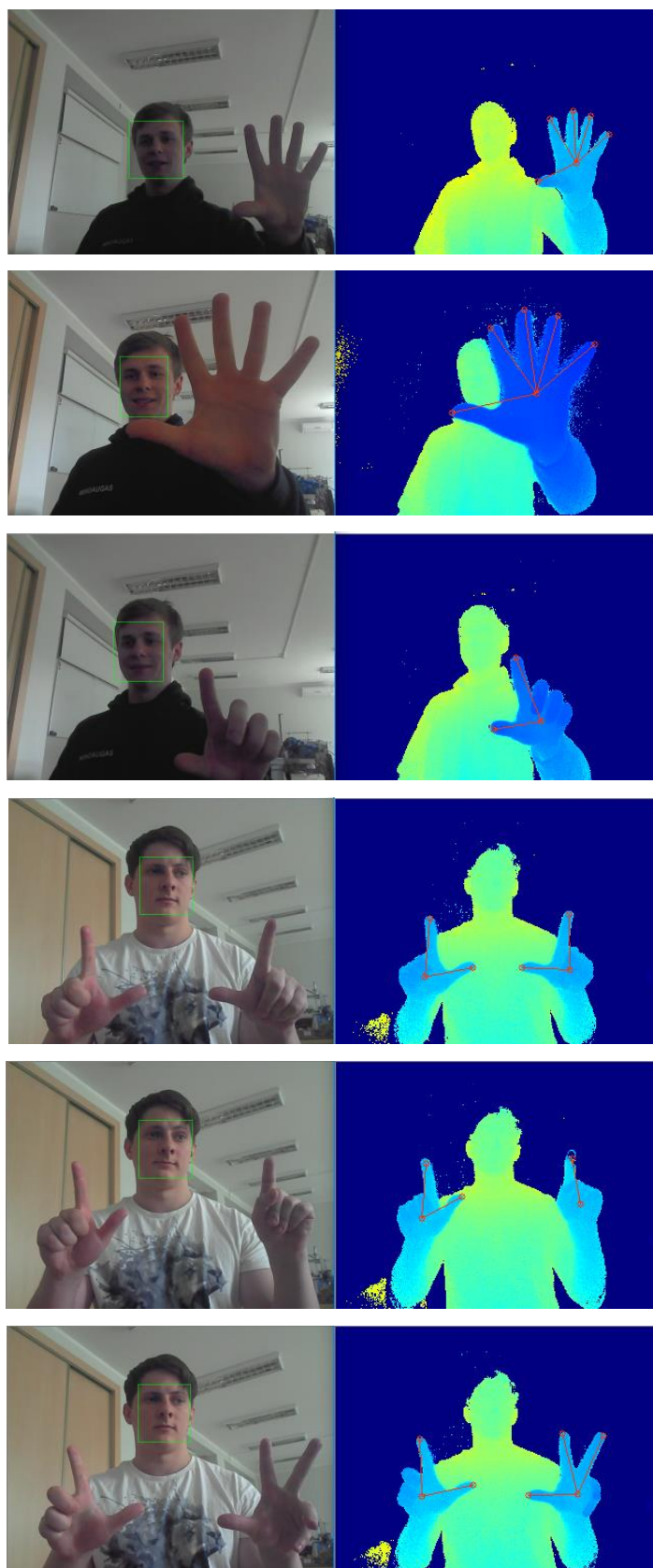
5.3.3 pav. RGB kameros duomenys su atpažintu veidu ir gylio kameros duomenys su atpažintu delno centru ir pirštų galų taškais
