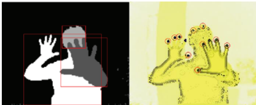
1.13 pav. Segmentacija. 4 regionai po 15cm kairėje ir FAST algoritmo taikymas pirštų galams rasti dešinėje[23]
