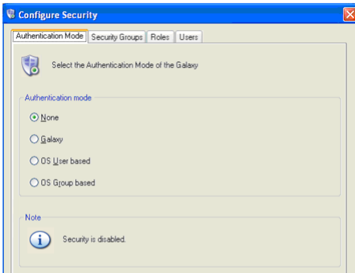
1.2 pav. Arcestra IDE patvirtinimo apsaugos konfigūravimo langas [3].
