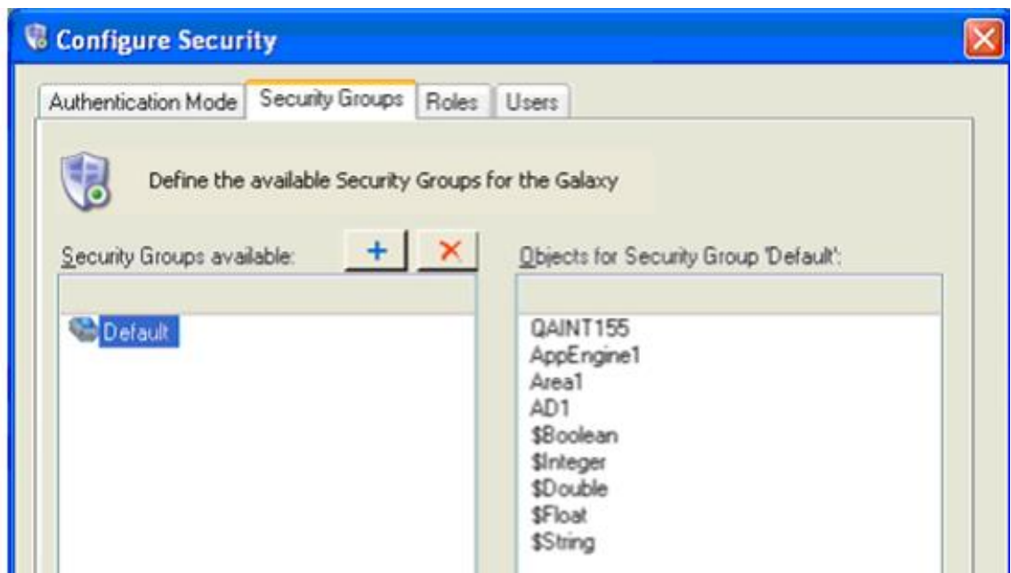
1.3 pav. Arcestra IDE apsaugos grupių konfigūravimo langas [3].
