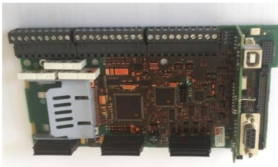
2.1 pav Dažnio keitiklio valdymo plokštė, sudaryta autoriaus.
