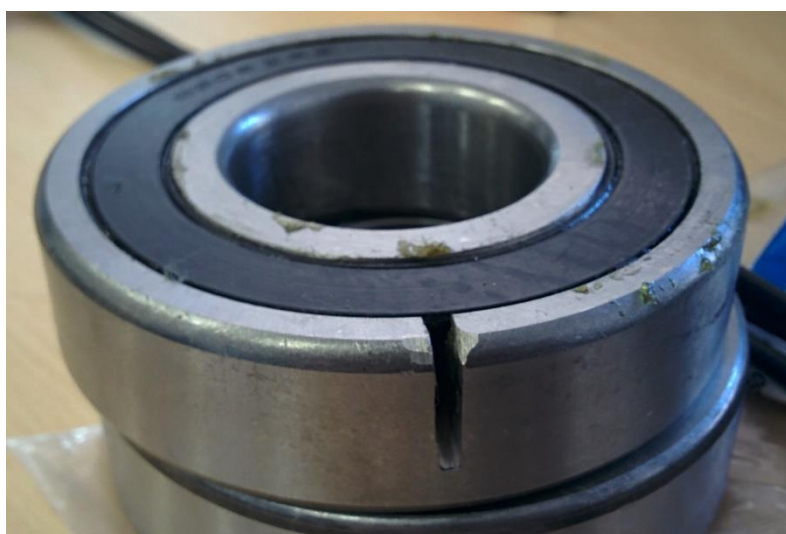
2.6 pav. Guolis su sugadintu išoriniu žiedu, sudaryta autoriaus
