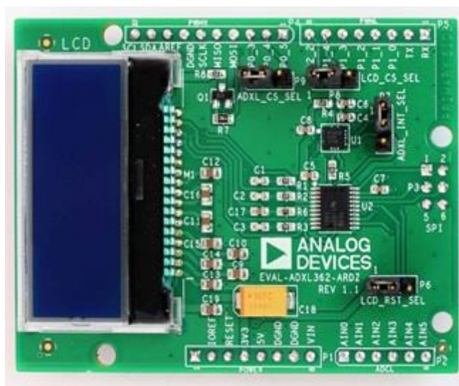
1.16 pav. Temperatūrą ir vibracijas stebintis prietaisas, šaltinis – analog.com
