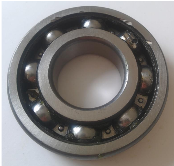
2.7 pav. Guolis su sugadintu separatoriumi ir rutuliuku, sudaryta autoriaus
