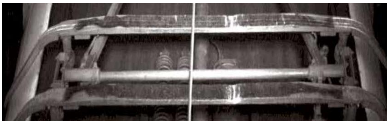
1.6 pav. Pantografo būklės stebėsenos įrenginio darbinis kadras [6].
