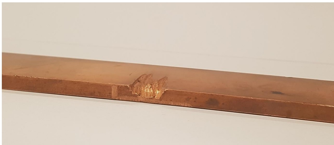
2.6 pav. Imituojama pantografo defekto forma.
