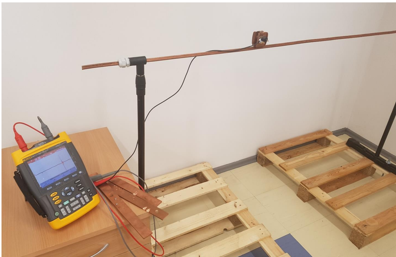
2.4 pav. Bandymo stendas su signalo priėmimo aparatūra.
