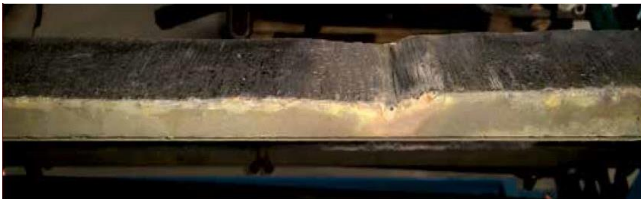
1.7 pav. Reali nuotrauka su pantografo pažeidimais [6].
