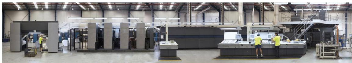
2 pav. GOSS M-600 ruloninė ofsetinė spaudos mašina
