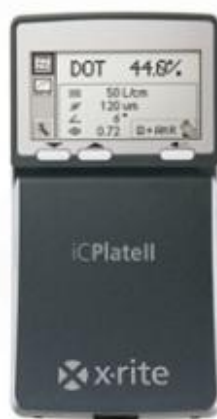
5 Pav. Icplate 2 plokščių matavimo prietaisas
