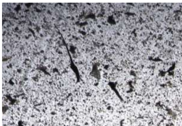
3.10 pav. Nuosėdų morfologinė sandara valant aliuminio elektrodais
