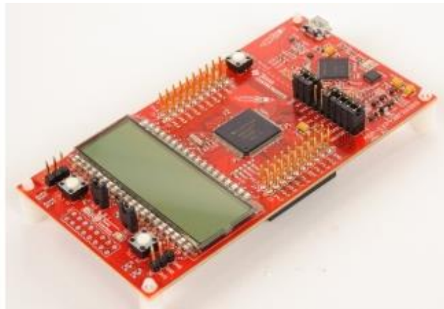
3.2.1 pav. „MSP430 Launchpad“ maketas su „MSP430 FR6989“ mikrovaldikliu (Texas Instruments Incorporated, 2017 [32])
