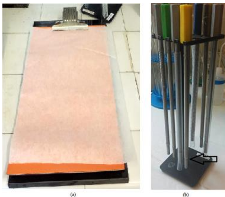
2.3 pav. Dangos liejimo stalas su filtriniu popieriumi (a) ir dangos liejimo lazdelės (b).
