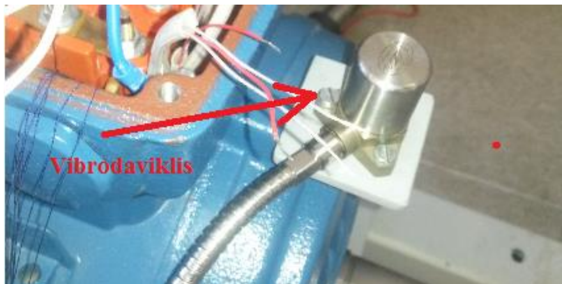
2.12 pav. Vibrodaviklis primontuotas prie variklio
