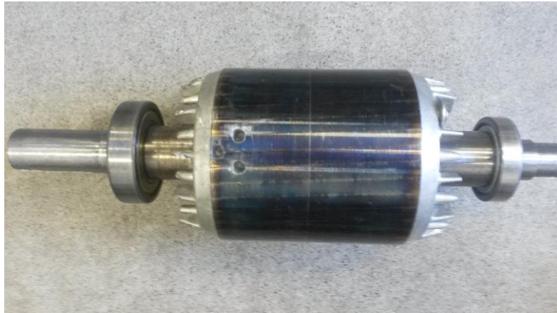
2.10 pav. Rotorius su nugręžtais trimis strypais
