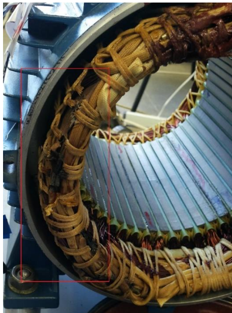
2.7 pav. Variklio statorius, kuriame yra trumpųjų tarpapvijinių sujungimų, nuotrauka autoriaus
