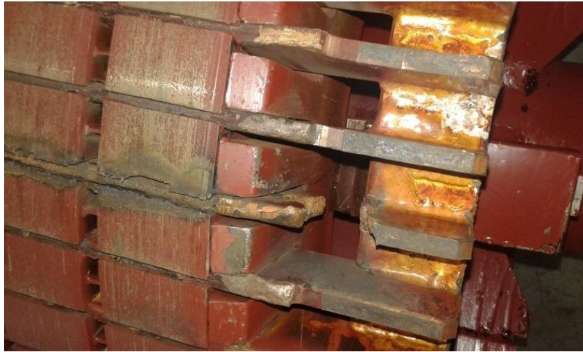
1.2 pav. Nutrūkęs rotoriaus strypas, šaltinis http://www.kalmer.si
