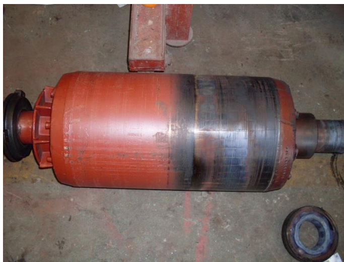
1.4 pav. Guolio gedimo sukulto oro tarpo ekscentriciteto žala rotoriumi, šaltinis
