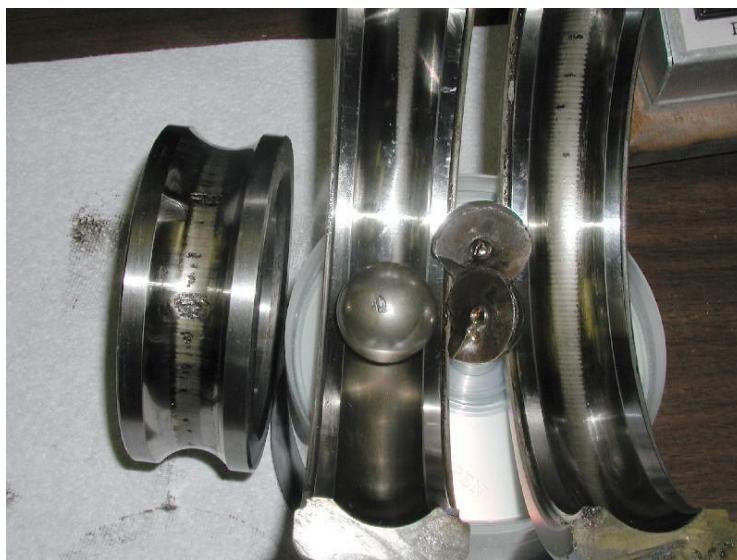
1.5 pav. Sugedęs guolis, šaltinis http://www.maintenance.org
