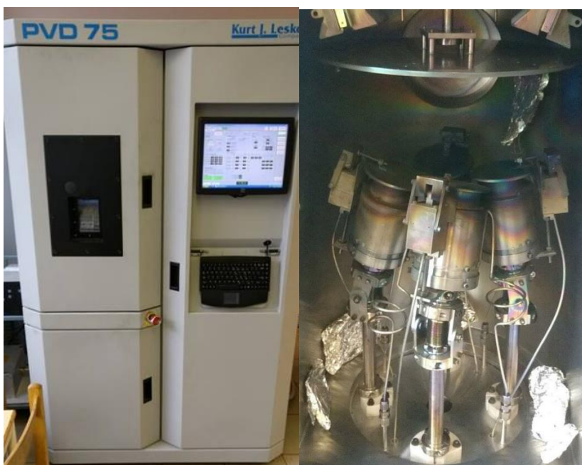
2.1.1 pav. Kurt J. Lesker PVD 75 sistema (kairėje) ir vakuuminė kamera su katodais (dešinėje)
