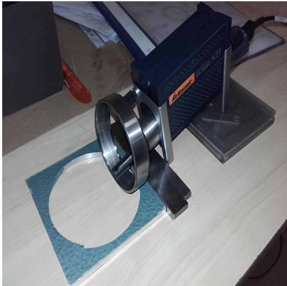
2.5 pav. Guolio išorinio žiedo paviršiaus šiurkštumo matavimas
