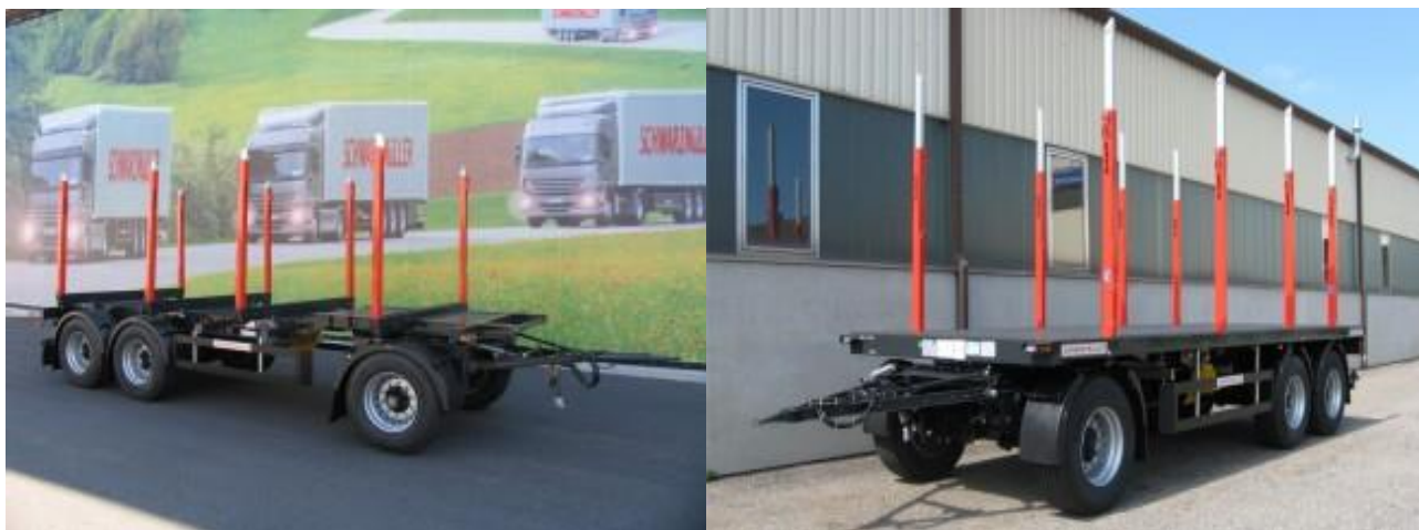
1.6 pav. a) – 3 ašių miškovežė priekaba be grindų ir b) – su grindimis [9; 10]
